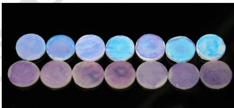
Рис. 1 – Фотография серии образцов гибридного композита и СИЦ, обработанных разными порошками, после окрашивания
