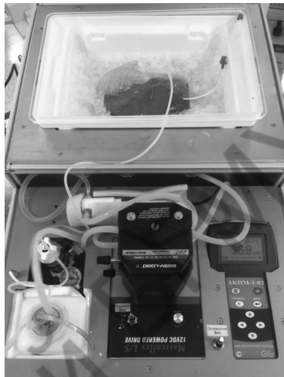
Рис. 2. Вид рабочей части испытательного стенда в процессе перфузии доли печени
