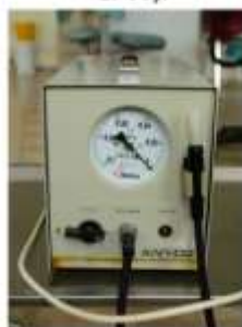
Аппарат для вакуумной пробы на стойкость капилляров (Кулаженко, 1960).
