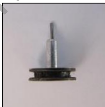
Рисунок 2. – Индентор с плоским концом иглы
