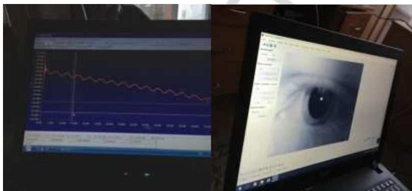
Рис. 2 – Одновременная регистрация движений глаз, электро- и видеоокулография
