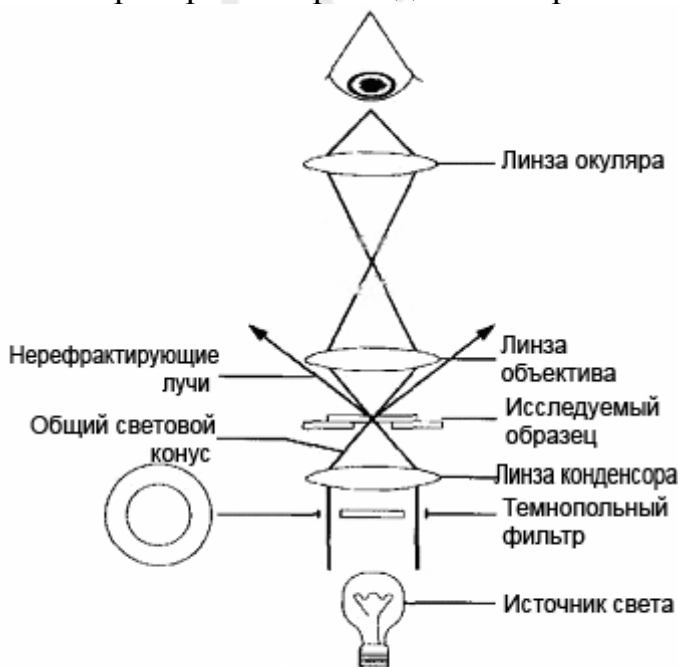
Рис. 4. Ход лучей в темнопольном микроскопе
