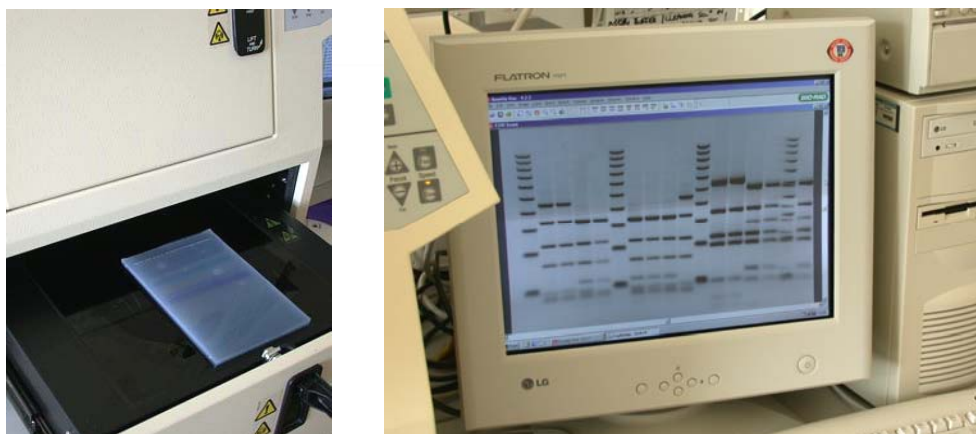
Рис. 35. Автоматизированная система визуализации гелей: трансиллюминатор, видеочамера, компьютер
