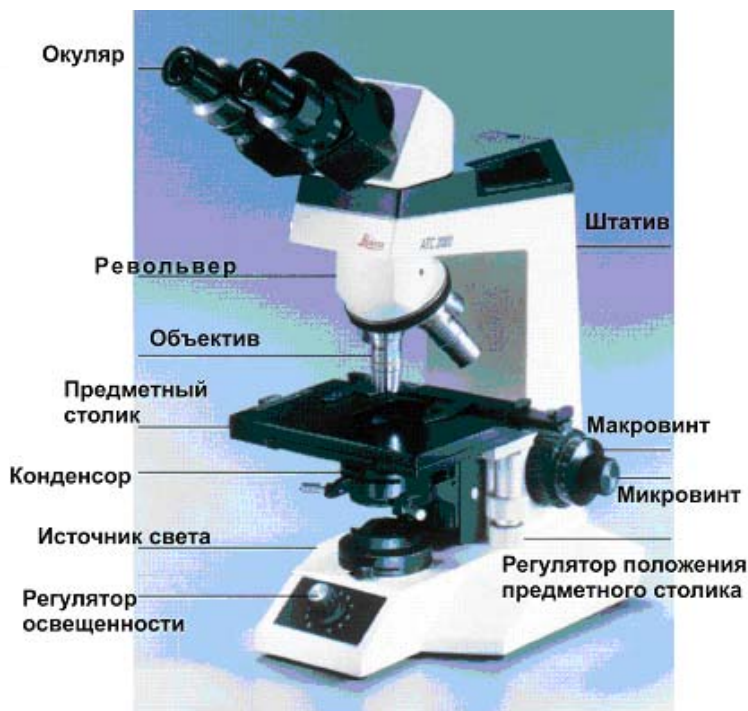
Рис. 1. Устройство светового микроскопа
