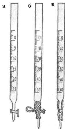
Рис. 3. Бюретки: а — с краном; б — с зажимом; в — с шариковым затвором
