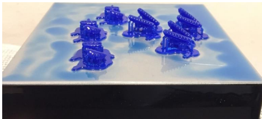
Рис. 67. Модели элементов экспандера, отпечатанные на 3D-принтере
