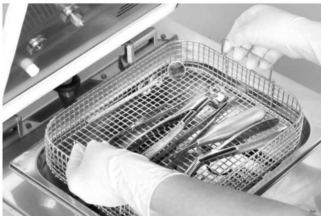
Рис. 4. Ультразвуковая мойка
