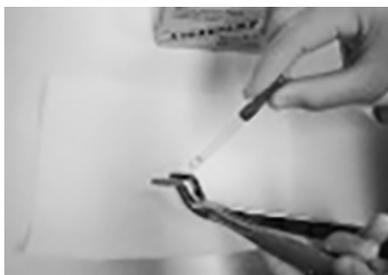
Рис. 3. Проведение азопирамовой пробы
