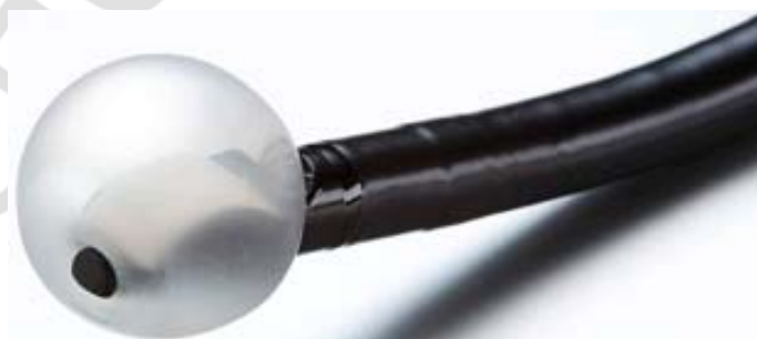
Рис. 19. Дистальный конец вводимого эндоскопического ультразвукографа с заполненным жидкостью силиконовым пузырем
