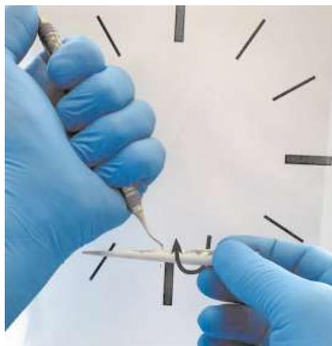
*Рис. 44.* Заточка лицевой поверхности инструмента
