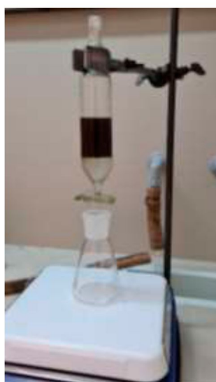
Рис. 4 – Экстракция кофеина в хлороформ для образца 4
