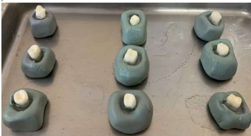
Рис. 3 – Зафиксированные в эпоксидной смоле образцы
