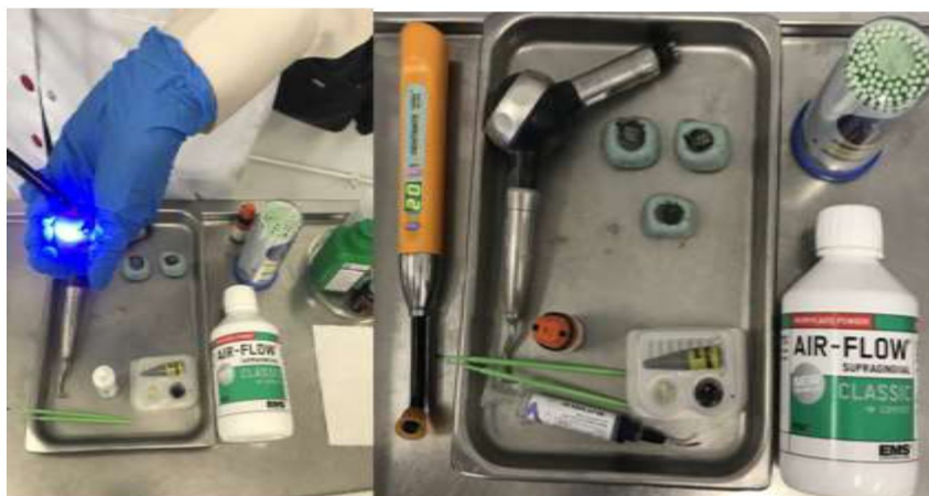
Рис. 4 – Обработка образцов адгезивом с ферромагнитным порошком
