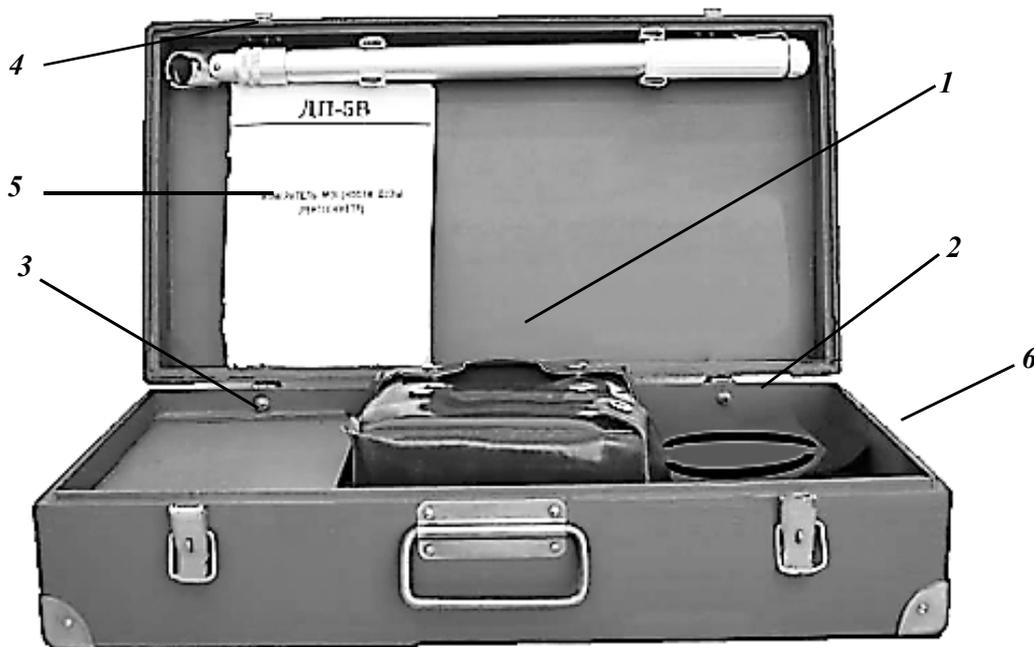
*Рис. 1. Общий вид комплекта прибора ДП-5В:*
