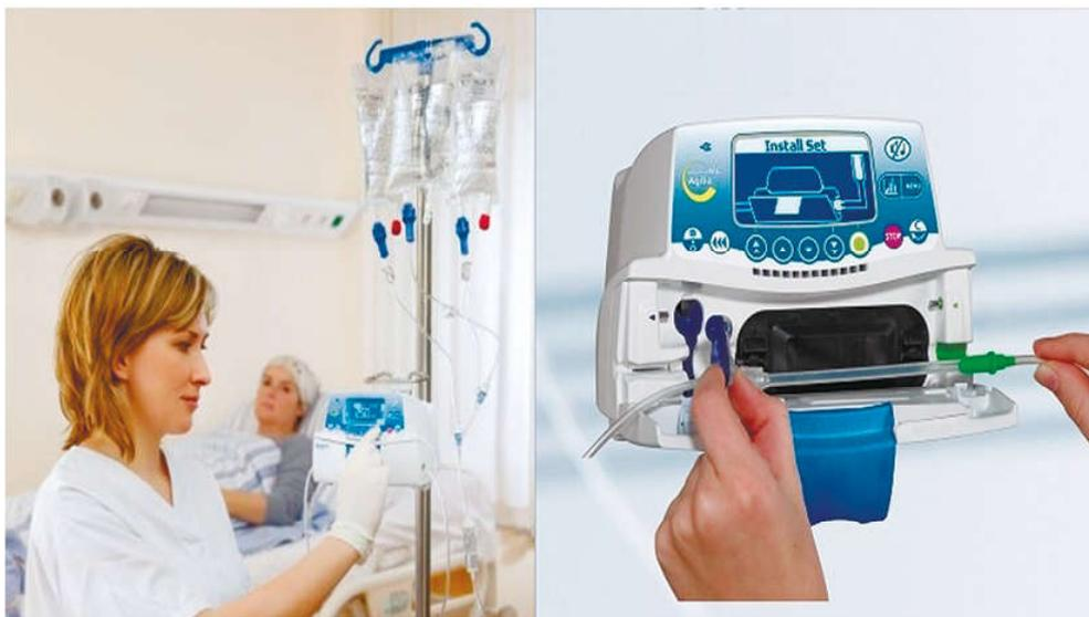
Рис. 3. Волюметрический насос
