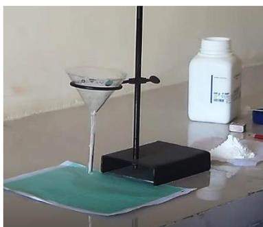
В сухую воронку, выходное отверстие которой закрыто, помещают без уплотнения навеску 50 г испытуемого образца, взвешенную с точностью  $\pm 0,5\%$ . Открывают выходное отверстие воронки и определяют время, необходимое для истечения испытуемого образца из воронки.
