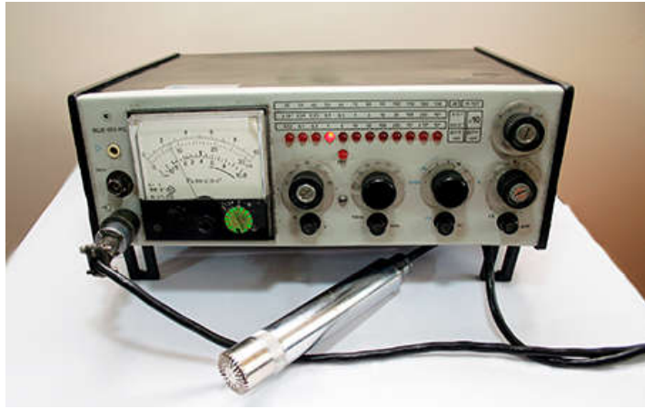
Рис. 1. Шумомер ВШВ-003-М2 — измеритель шума и вибрации. Используется для определения источников и характеристик шума и вибрации
