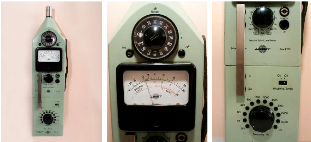
Рис. 2. Шумомер Bruel & Kjaer 2203 — прибор для оперативных замеров шума
