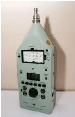
Рис. 3. Шумомер интегрирующий Bruel & Kjaer 2218 — прибор для измерения уровня шума
