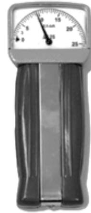
Fig. 6.1. Manual dynamometer
