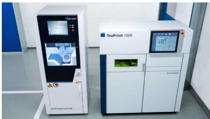
Рисунок 12. Комплект оборудования для зуботехнических работ по производству зубных протезов по технологии селективного лазерного спекания
