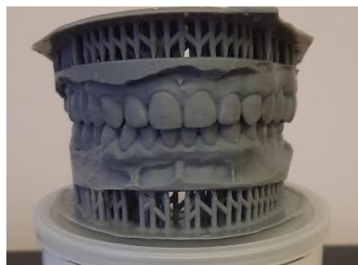
Рисунок 32. Напечатанные мастер-модели зубных рядов после Mock-up моделирования в лаборатории
