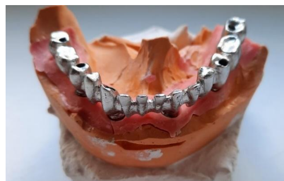
Рисунок 14. Каркас зубного протеза "all on 6" на нижнюю челюсть после печати методом селективного лазерного спекания
