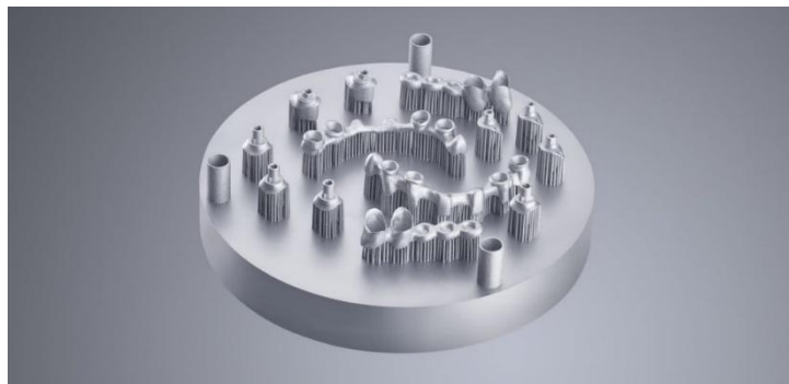
Рисунок 11. Индивидуальные абатменты, каркасы протезов после селективного лазерного спекания
