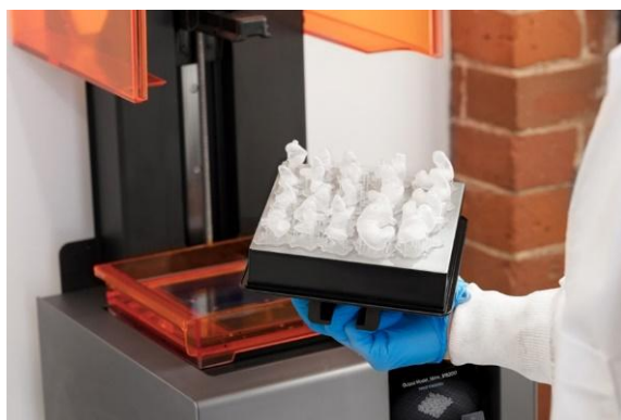
Рисунок 7. Кювета с напечатанными зубными протезами различной конструкции
