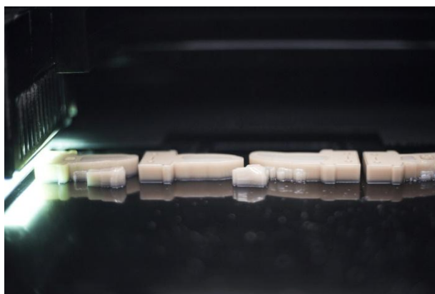
Рисунок 9. Процесс создания пластиковой заготовки по технологии PolyJet
