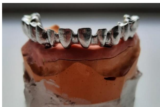
Рисунок 13. Каркас зубного протеза "all on 6" на верхнюю челюсть после печати методом селективного лазерного спекания
