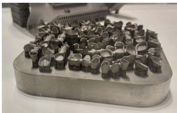
Рисунок 10. Каркасы зубных протезов после селективного лазерного спекания
