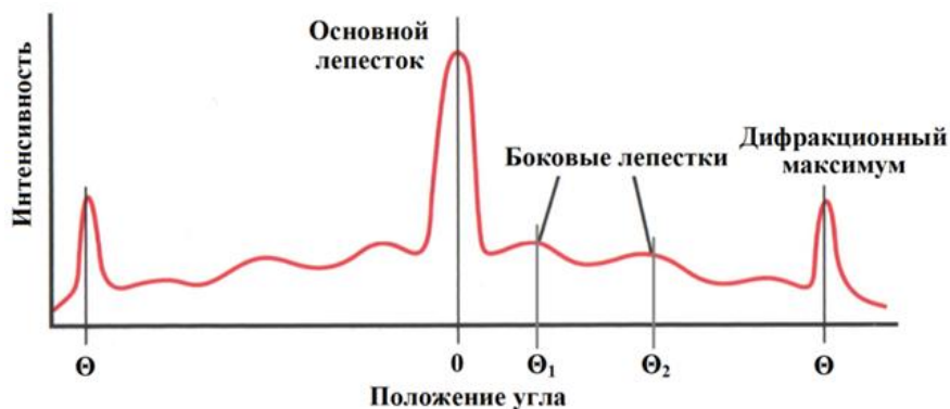
Рисунок 11. Диаграмма, демонстрирующая положение боковых лепестков и дифракционного максимума фазированного датчика
