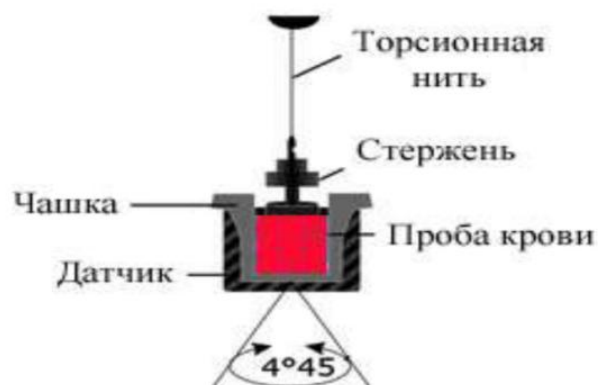
Рисунок 6 - Схема метода тромбоэластографии/тромбоэластометрии
