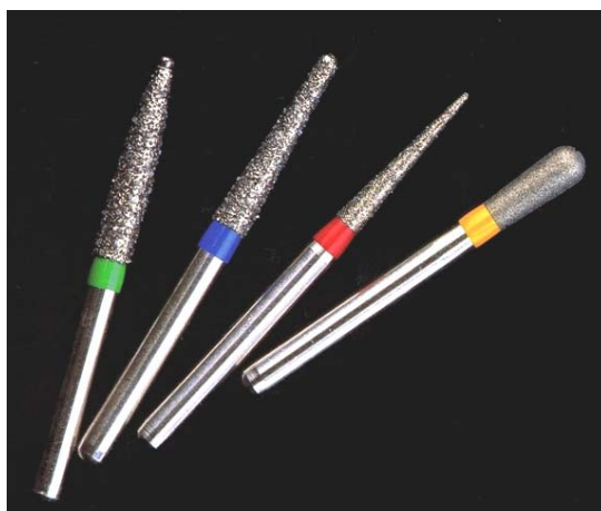
Рис. 4. Цветовая маркировка алмазных боров
