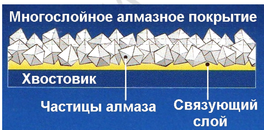
Рис. 5. Схема рабочей (режущей) части алмазного бора
