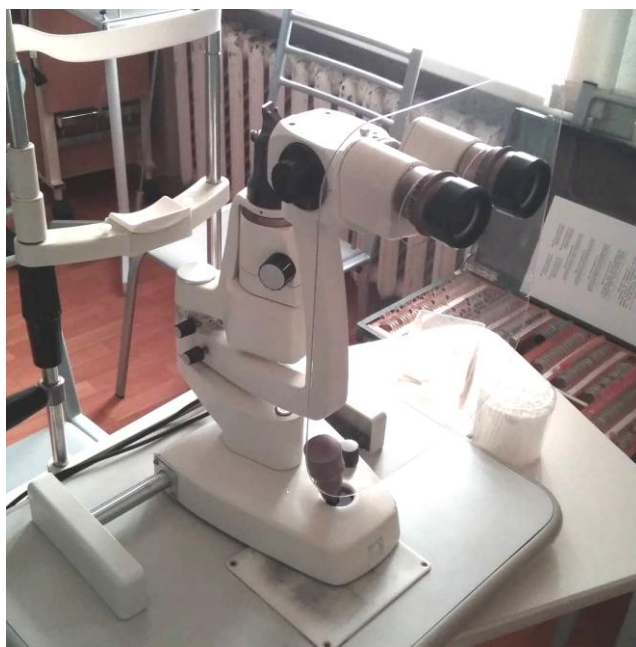
Рисунок 6. Защитный экран для щелевой лампы в нашей модификации.
