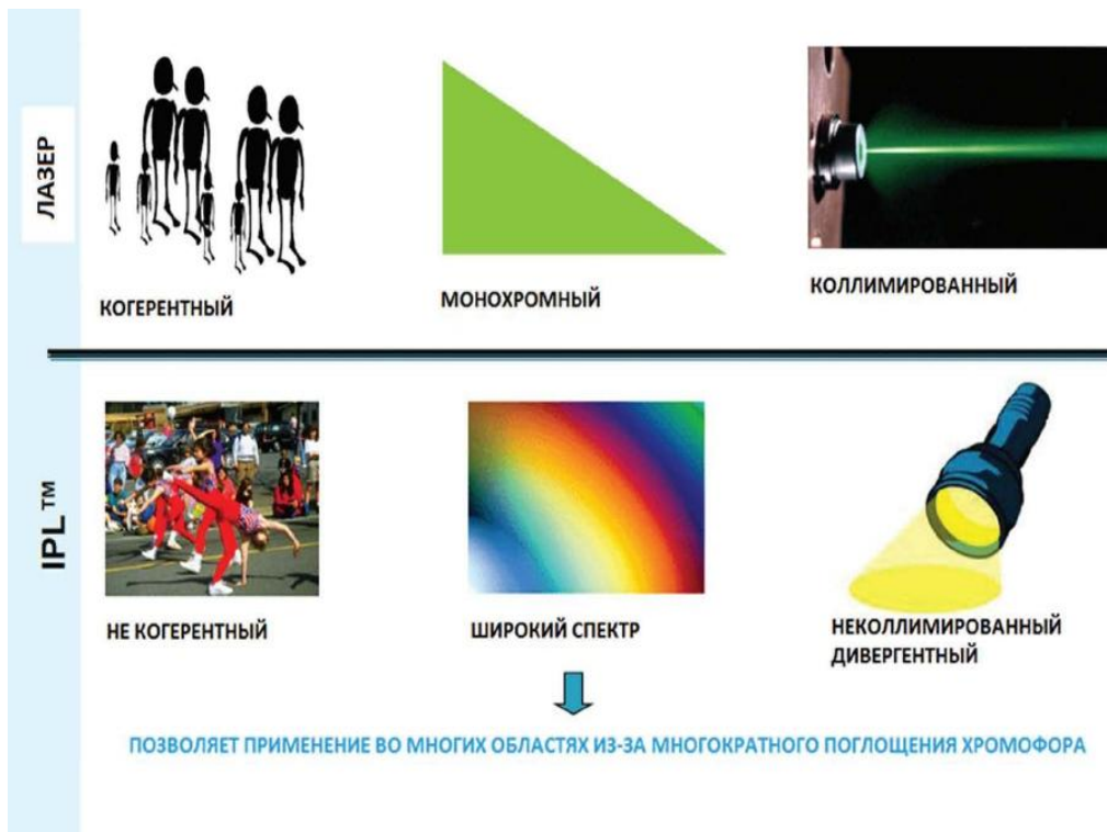
Рис. 4. – Отличия лазерного и IPL-излучения.
