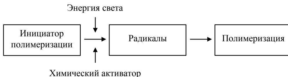
Рис. 1. Схема полимеризации композитного материала свободными радикалами
