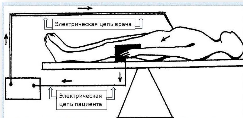
Рис. 7. Электрическая цепь врача и пациента при использовании монополярной электрохирургии
