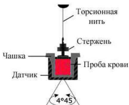
Рис. 3 – Принцип работы тромбозластографа TEG® 5000.
