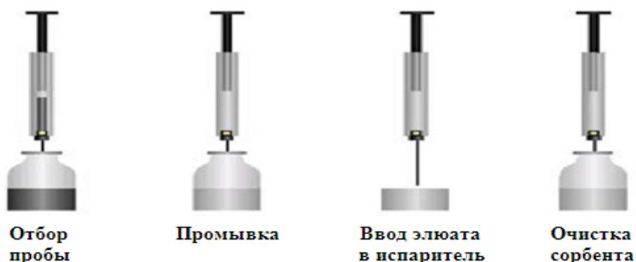
Рисунок 3. Этапы твердофазной микроэкстракции
