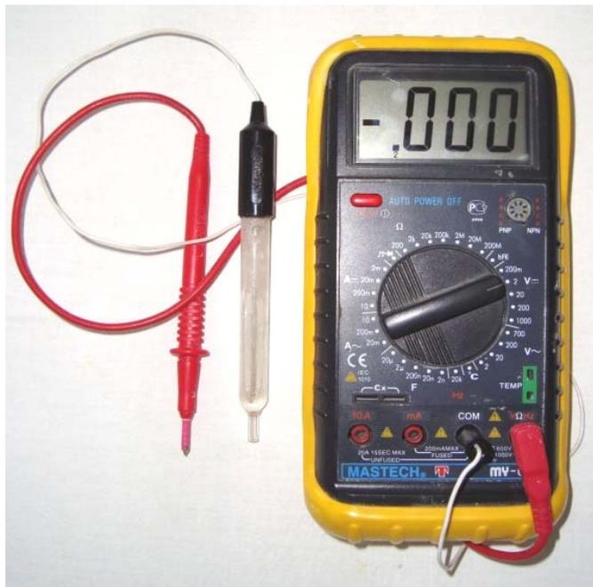
Рис. 1. Комбинированный электроизмерительный прибор MASTECH
