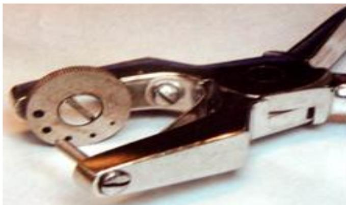
Рисунок 14. Пробойник с отверстиями разного диаметра
