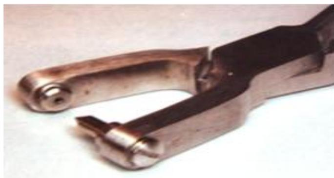
Рисунок 15. Пробойник с одним отверстием
