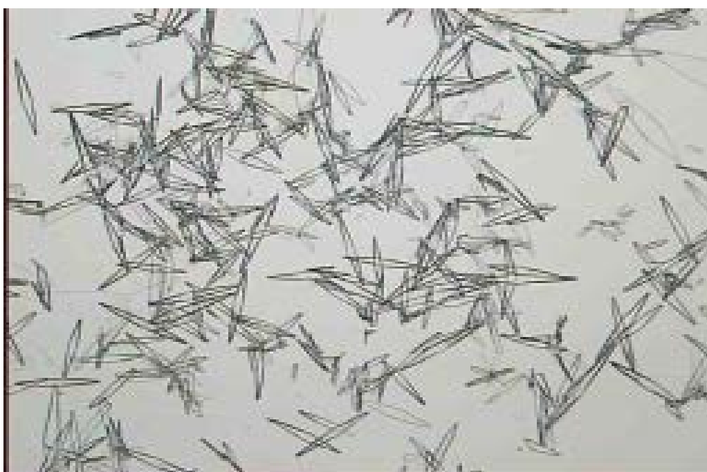
Рисунок 6 – Микрофотография кристаллов нитробарбитурата магния. Увеличение 100х
