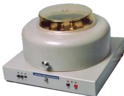
Рисунок 4.13 – Низкоскоростная центрифуга ОПНЗ (РФ).
