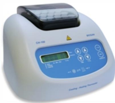
Рисунок 4.9 – Термостат с функцией охлаждения и нагрева СН-100 (BioSan, Латвия).
