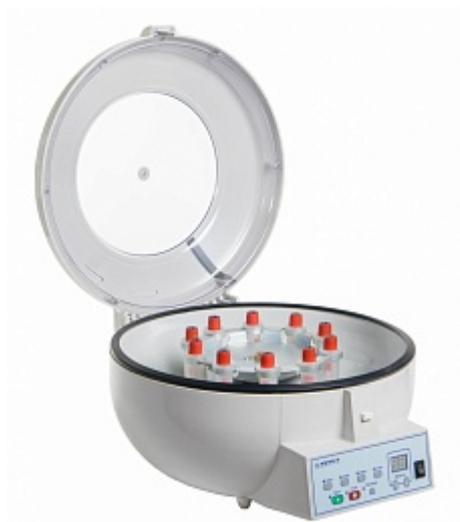
Рисунок 4.14 – Низкоскоростная центрифуга ЦЛМН-Р10-01 ЭЛЕКОН (РФ).
