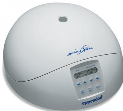
Рисунок 4.17 – Микроцентрифуга «MiniSpin» (Eppendorf).
