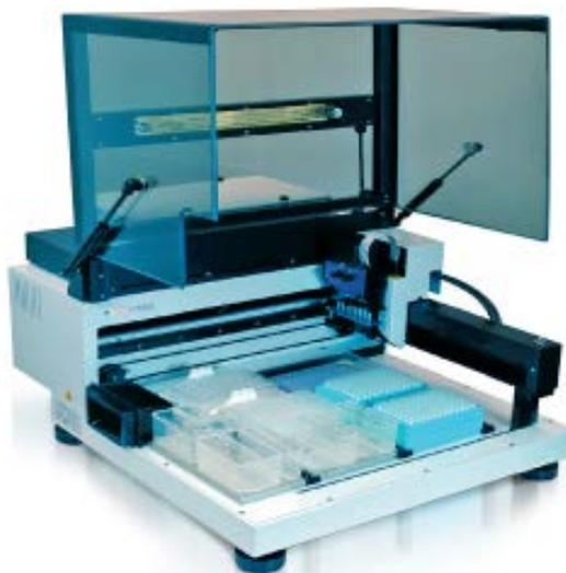
Рисунок 4.39 – Система автоматическая для выделения нуклеиновых кислот CAS-1820 X-Tractor Gene™ (Corbett Research, Австралия)
