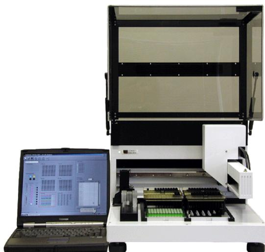
Рисунок 4.48 – Система автоматического раскапывания ПЦР смесей CAS-1200/4200/4800 (Corbett Robotics, Австралия)
