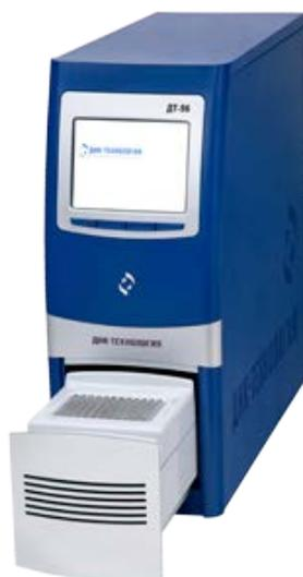
Рисунок 4.53 – Амплификатор ДТ-96 (ДНК-Технология)
