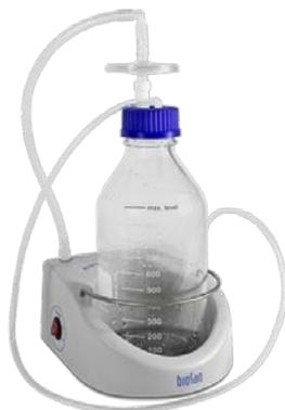
Рисунок 4.29 – Аспиратор с колбой-ловушкой FTA-1 (Biosan, Латвия).
