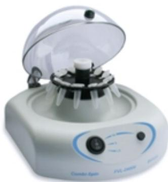
Рисунок 4.24 – Мини центрифуга/вортекс Комбиспин FVL-2400N (BioSan, Латвия).
