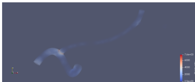
Рисунок 4 – Градиент скорости на стенках использованной геометрической модели
