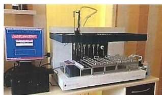
Рис. 51. Автоматизированный процесс для приготовления цитологических препаратов и окрашивания их по Папаниколау:
