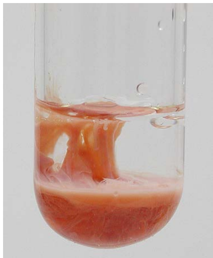
Рис. 7. Оранжевый преципитат образовавшийся, при смешивании гипохлорита натрия и хлоргексидина биглюконата.
