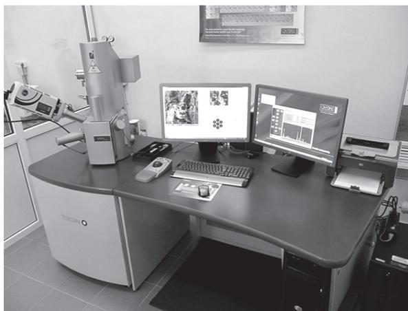
**Рис. 1. Сканирующий электронный микроскоп MIRA с рентгеноспектральным микроанализатором**
