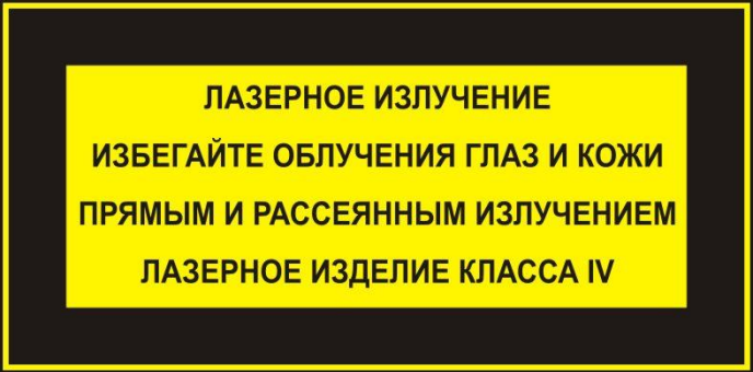
Рис. 3. Предупреждающий (а) и пояснительный (б) знаки лазерной опасности
