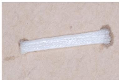
*Рис. 8.* Просушивание пропитанной ленты при помощи салфетки
