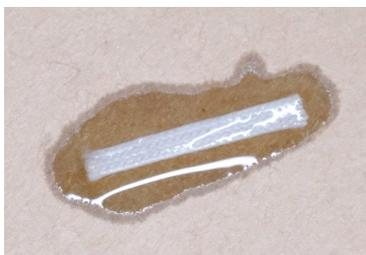
*Рис. 7.* Пропитывание армирующей ленты смолой (силаном)
