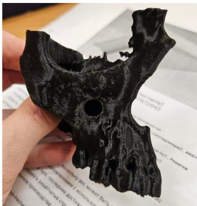
**Рис. 1. Напечатанная модель кости с персонализированно рассчитанной областью предстоящего трепанационного отверстия**
