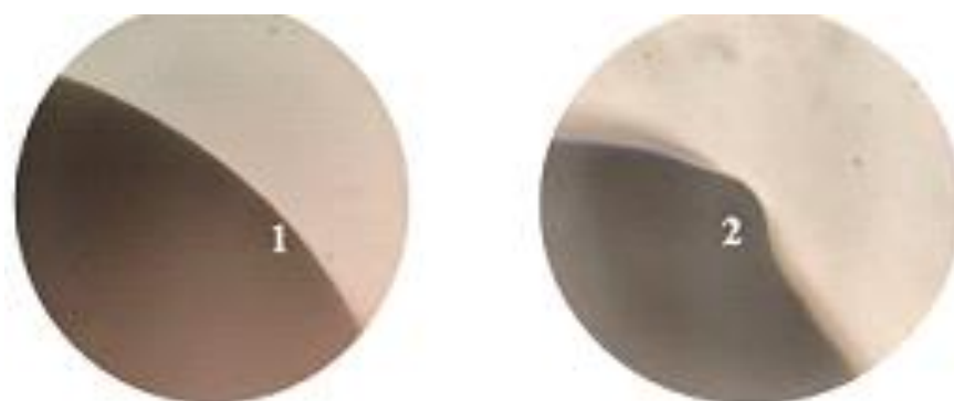
Рис. 6. Поверхность бонда (1) и композиционного материала (2) после использования силиконовых микроаппликаторов. Световая микроскопия. Ув. \times 100
