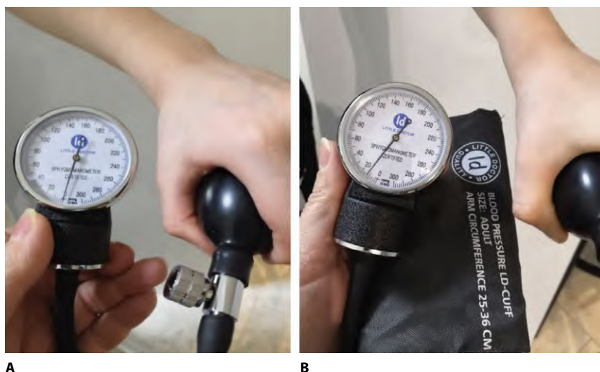
Рис. 1. Тест силы захвата (установка на исходную нулевую отметку (А) и результат (В) в мм рт. ст. при сжатии) Fig. 1. Grip strength test (the setting to the initial zero mark (A) and the result (B) in mmHg during the compression)
