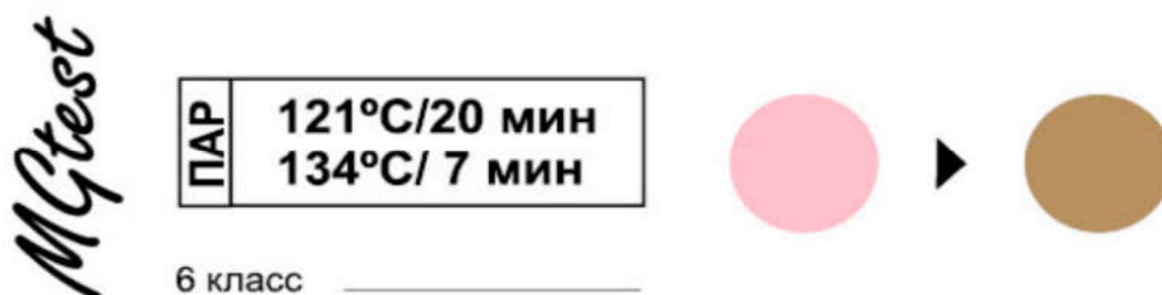
Рис. 19. Индикатор (эмулятор) паровой стерилизации
