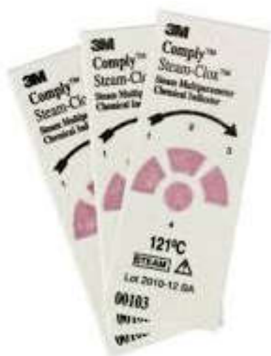
Рис. 17. Индикатор химический мультипараметрический
