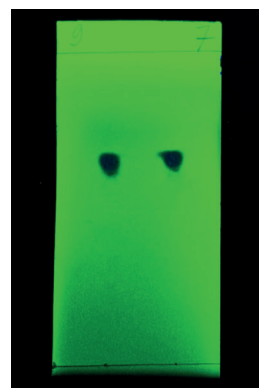
Рис. 4. Результат хроматографического разделения в системе 3 и проявления путем облучения в УФ-свете при 254 нм
