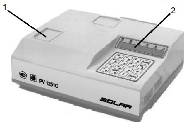
Рис. 20. Общий вид спектрофотометра PV 1251: 1 — крышка кюветного отделения; 2 — панель управления
