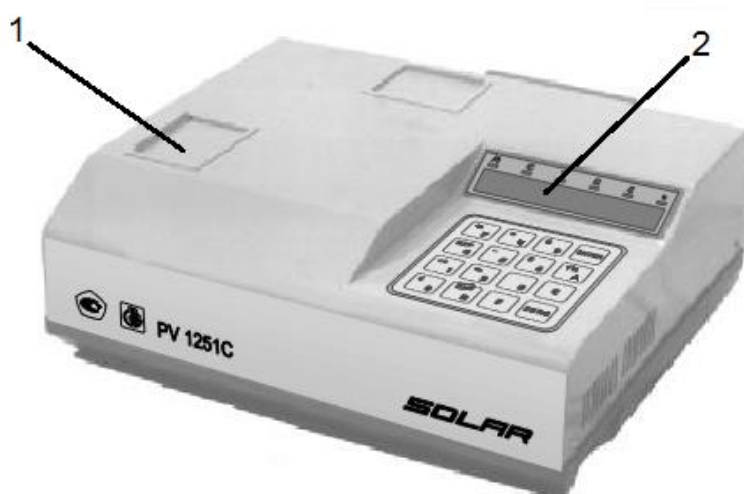
Рис. 11. Общий вид спектрофотометра PV 1251: 1 — крышка кюветного отделения; 2 — панель управления
