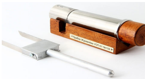
Рис. Прибор Журавлева для выемки мякиша при определении пористости хлеба
