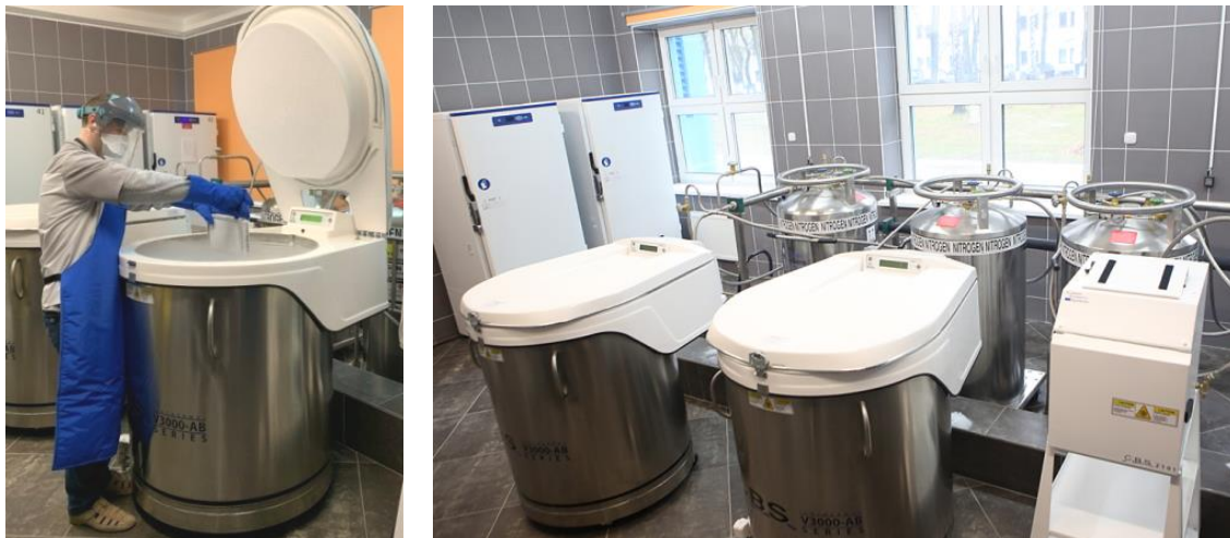
Рис. 4.17. Загрузку контейнеров с эритроцитами в жидком азоте со сроком хранения более 10 лет
