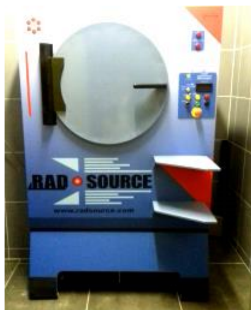
Рис. 4.20. Устройство рентгеновского облучения крови
