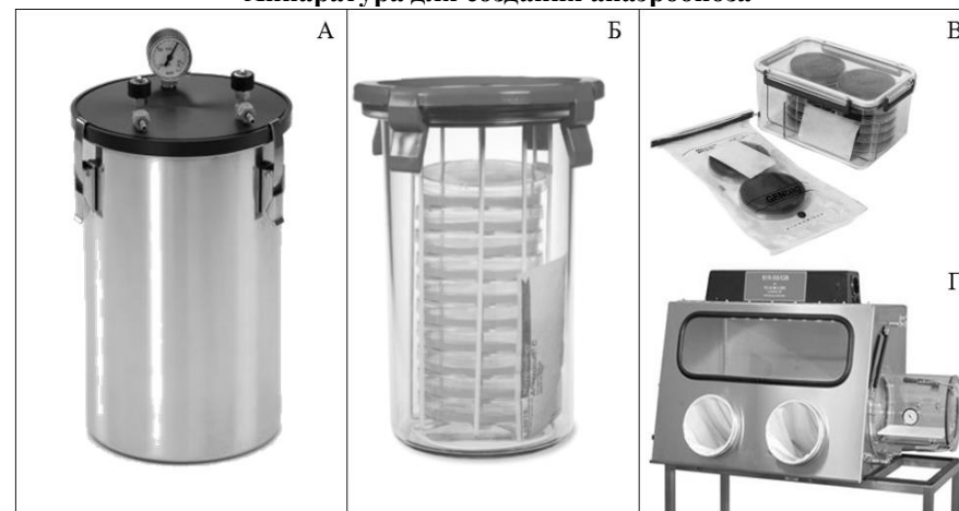
А — микроанаэростат, Б, В — вакуумный контейнер с газогенерирующими пакетами, Г — стационарный анаэробный бокс
