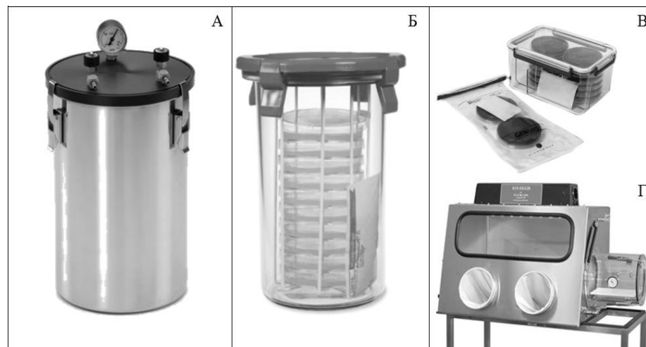
А — микроанаэростат, Б, В — вакуумный контейнер с газогенерирующими пакетами, Г — стационарный анаэробный бокс
