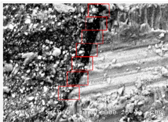
Рис. 4 – Подсчет количества пор при работе адгезивной системой IV поколения
